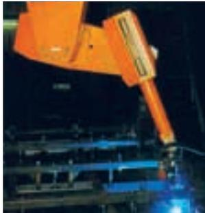
Der Rahmen wird aus verschachtelten Stahlprofilen zusammen mit der V-Dechsel auf **modernsten Roboteranlagen verschweißt**. Die **robuste Konstruktion** ist ideal für extremste Einsatzbedingungen.
