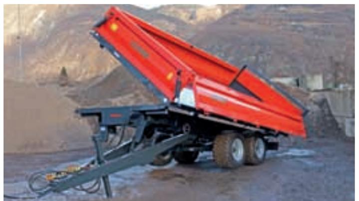
RM-RMT 140 T mit hydraulischer Deichsel
